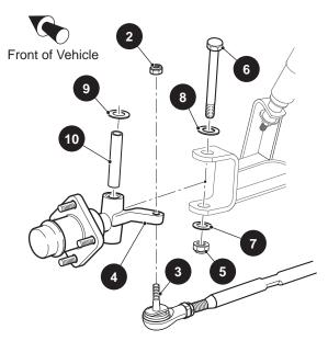
Fig. 18 Spindle Replacement
