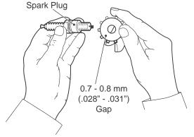
Fig. 17 Gapping the Spark Plug
