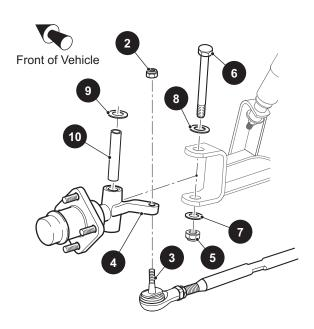
Fig. 18 Spindle Replacement
