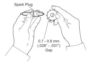
Fig. 17 Gapping the Spark Plug
