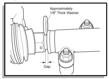
Fig. 20 Checking Gap
