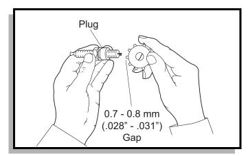
Fig. 17 Gapping The Spark Plug
