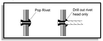
Fig. 1 Drill Out Metal Rivet
