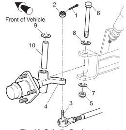
Fig. 16 Spindle Replacement
