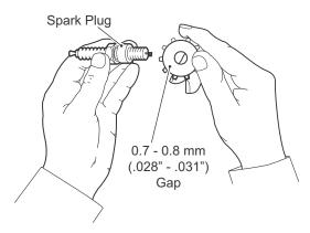
Fig. 17 Gapping the Spark Plug
