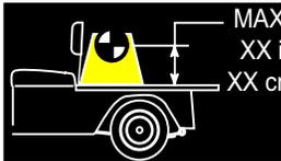
LOAD CENTER OF GRAVITY, MAXIMUM HEIGHT
